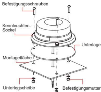
1. Bohren Sie Löcher in die Montagefläche für den Kabelausgang und die Befestigungsschrauben.
