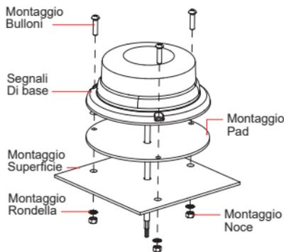
1. Praticare dei fori sulla superficie di montaggio per uscita del filo e bulloni di montaggio.
