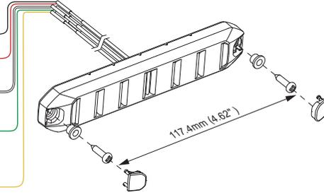
**Funcionamiento****Para la selección del patrón de destellos:**Cada Modo de Aviso puede seleccionar y guardar un Patrón de Destello. Mientras activa un Modo de Advertencia, aplique momentáneamente el cable **AMARILLO** a +VDC:
